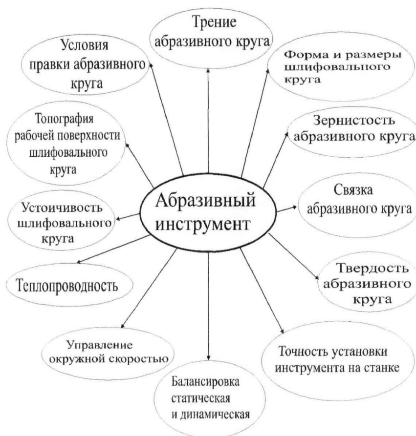
Рис. 2. Воздействие абразивного инструмента на формирование поверхностного слоя
